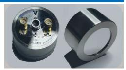
成都晶威科技有限公司开发的 AP 系列前置型 PIPS 探测器,在封装内部集成了 PIPS 探测器和低噪声的电荷灵敏前置放大器,整个探测器拥有小巧坚固的外壳和内部精巧的设计。前置放大器可以非常方便的直接连接到后端设备当中。
