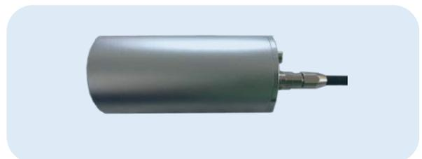
SiC 具有禁带宽度大、抗辐射能力强、击穿电场强度高、饱和电子漂移速度大等特点，是制作耐高温和抗辐射器件极佳的宽禁带半导体材料相较于传统 Si、Ge 半导体探测器而言，SiC 探测器具有优异的耐高温和抗辐照性能。
